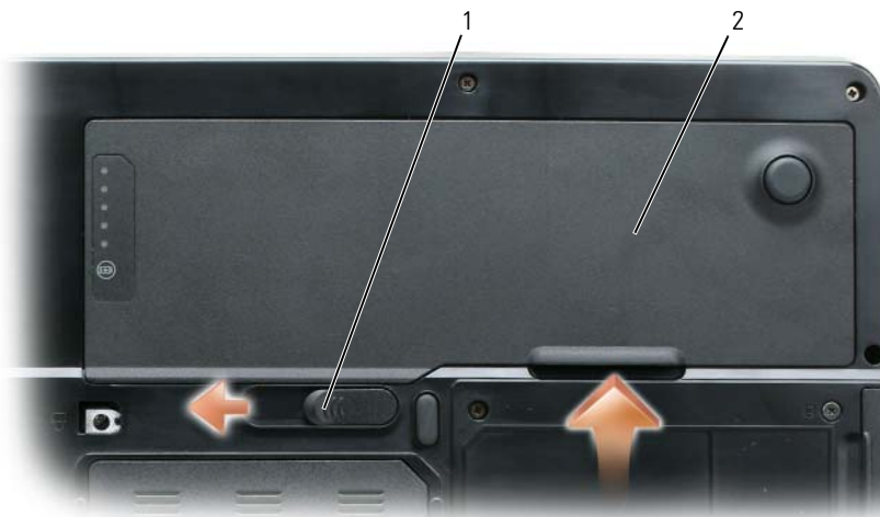
1 brava na pregradi za bateriju 2 baterija
